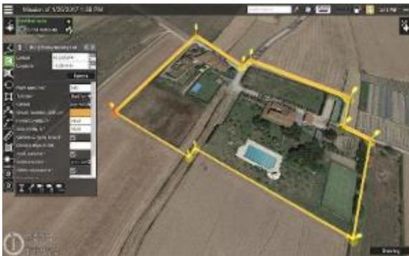
Программное обеспечение для планирования полетов, управления беспилотниками и производства карт по данным аэрофотосъемки
